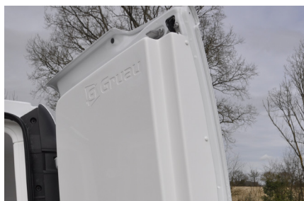
Isolation des ouvrants d'origine par des contre-portes isothermes.
