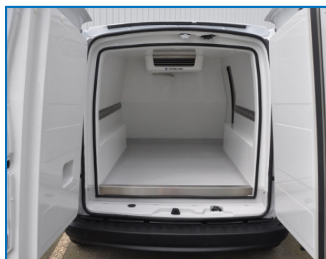
Isolation des ouvrants d'origine par des contre-portes isothermes.
