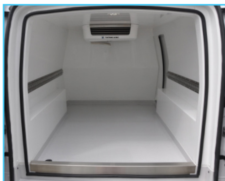
Plancher antidérapant avec caissons de passages de roues.
