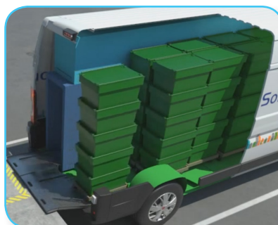
Séparation des denrées suivant leur température de consigne
